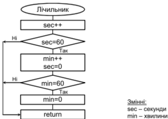
Рис. 4. Блок-схема підпрограми відліку часу
