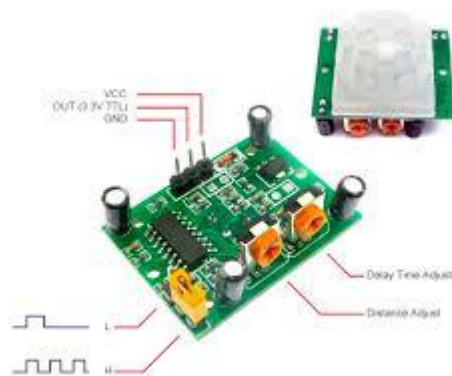
Рисунок 9.1 – Зовнішній вигляд датчика руху (присутності) HC-SR501
