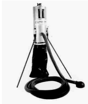
Рис. 2.56. Пиловловлювач (Junior) з одним всмоктувальним шлангом
