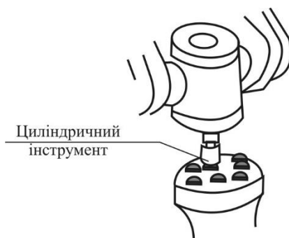
Рис. 2.49. Спосіб реконструювання твердосплавної напайки
