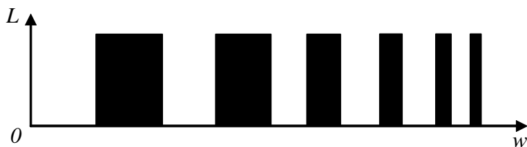
Рис. 4.18. Тест-об'єкт із східчастою різницею яскравостей: L - яскравість; w - просторова частота решітки
