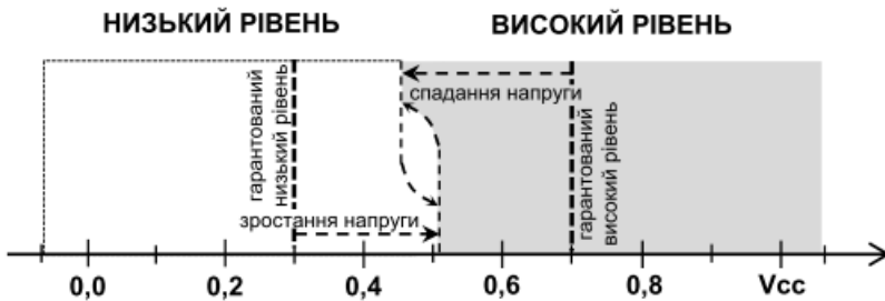
Рис. 3.4. Розподіл рівнів відносно напруги живлення МК з врахуванням гістерезисної петлі тригерної заскочки
