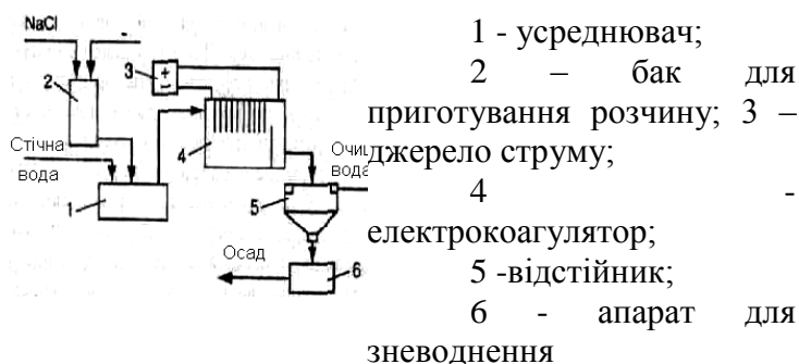
Рис. 7.1. Схема електорокоагуляційної установки
