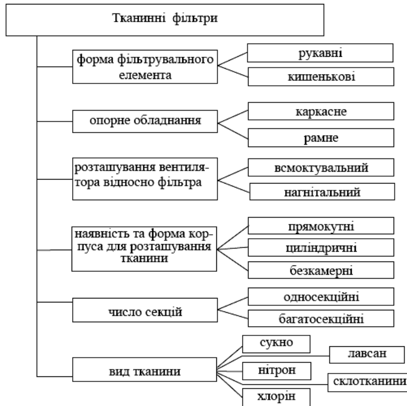
Рис .3.1. Класифікація тканинних фільтрів
