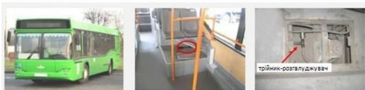
Рис. 3.11. Місце монтажу трійника -розгалуджувача на автобус МАЗ 103.
