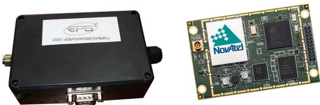
Рис. 4.1 Зовнішній вигляд GPS-приймача EPSPak-I-AG та плати NovAtel OEMStar, відповідно.
