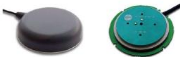
Рис. 4.2 Зовнішній вигляд та вигляд у розрізі зовнішньої виносної антени NovAtel/Antcm G3, відповідно.
