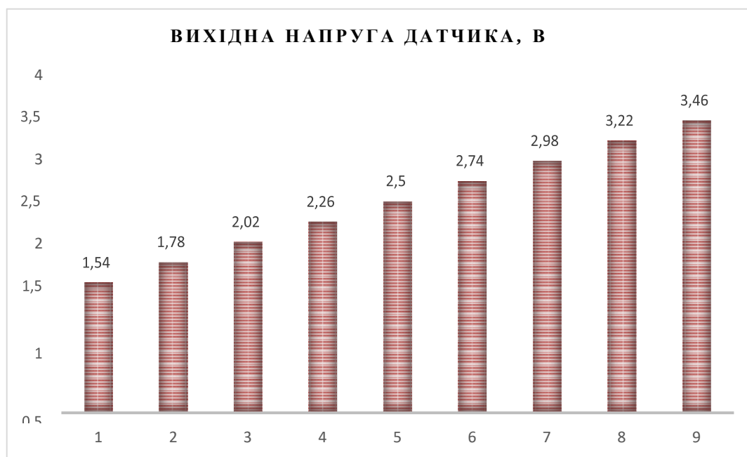
Рис. 3.10. Графік залежності вихідної напруги датчика GNOM DDE від вхідного тиску.
