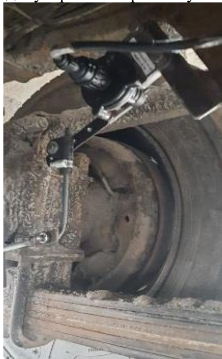
Рис 3.6. Монтаж датчика на вісь автобуса Атаман ISUZU
