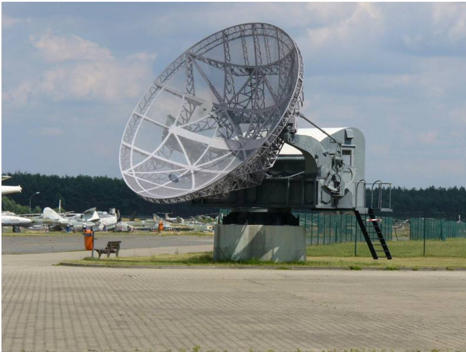
Приклад дзеркальної антени з сітчастим рефлектором
