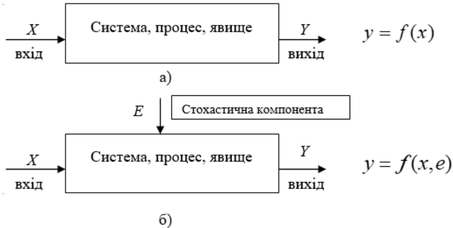
Рис. 1.21 – модель «вхід – вихід»: а – детермінована, б – стохастична
