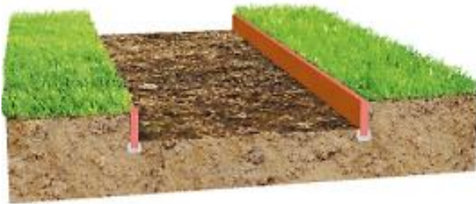
Рис.6.3. Приклад обрамленого бордюром котловану
