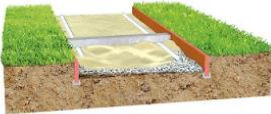
Рис. 6.5. Приклад облаштованого шару підсипки
