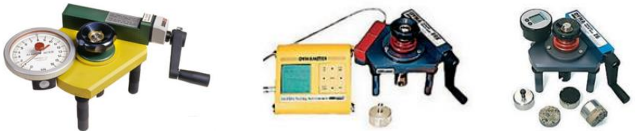
Рис.3.2. Адгезіометр в різних конструкційних виконаннях
