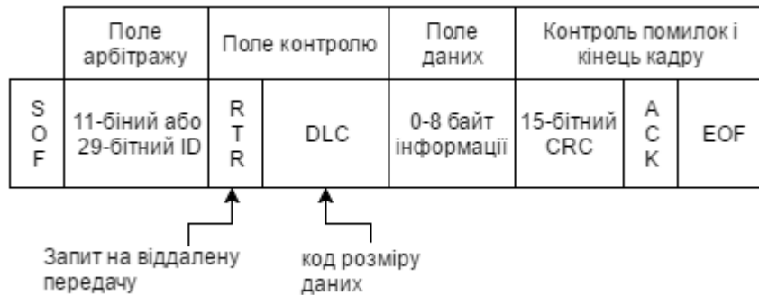
Рисунок 4 – Формат пакета повідомлень CAN
