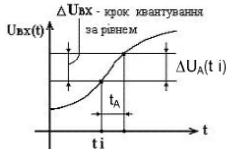
Рисунок 2- Визначення апертурної похибки біля i -ї точки відліку
