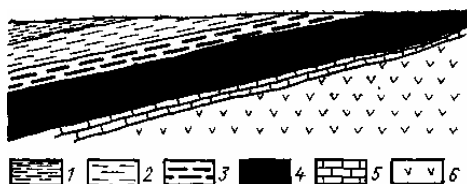
Рис. 7.1. Схематический геологический разрез Кузейского месторождения графита (по С.В. Обручеву): 1 – песчаники; 2 – сланцы и кварциты; 3 – графитовые сланцы; 4 – графит, образовавшийся по пласту угля; 5 – карбонатные породы; 6 – диабазовые траппы
