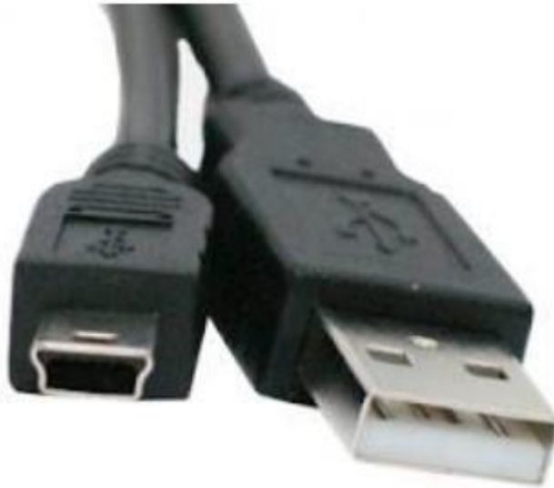
Рис. 2.1. Конектори кабелю для приєднання STM32F4Discovery до ПК
