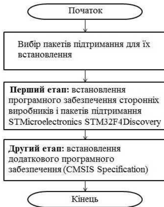
Рис. 8.1 – Алгоритм налаштування Matlab Simulink для програмування мікроконтролера STM32F4discovery
