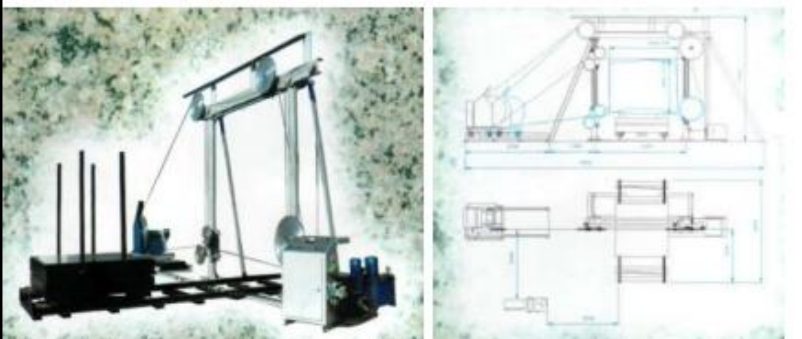
Установка пасерувальна (Diamond wire blocktailor).
