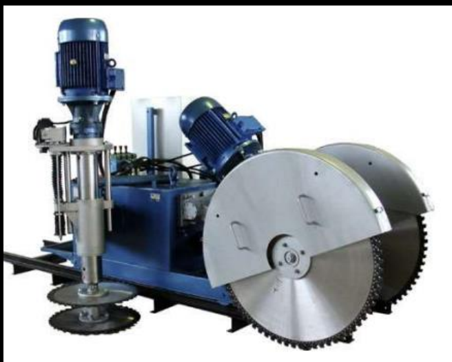
Низькоуступна машина для видобутку стінового каменю „ПРИМА“
