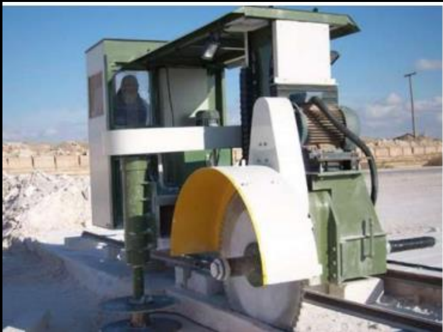
Машина з дисковими пилами низькоуступна (підшвоуступна)
