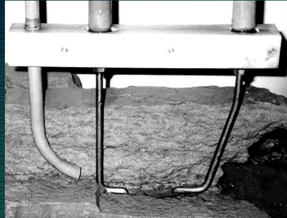
Процес різання піщаника за електроімпульсним способом
