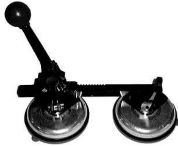
Рис. 2.15. Вакуумні захвати для склеювання розколотих половинок виробу та виконання різноманітних робіт [2]
