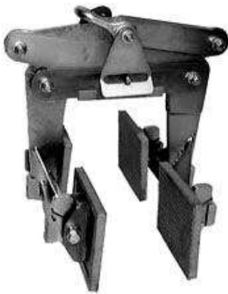
Рис. 2.21. Вантажні механічні захвати для механізованого переміщення виробів з природного каменю [2]:
