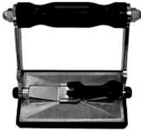
Рис. 2.16. Вакуумні захвати для ручного вкладання, переміщення заготовок та готових виробів з каменю [2]
