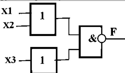
На рисунку надана схема на логічних елементах. Вкажіть, яка логічна функція реалізується схемою.
