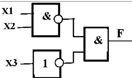
На рисунку надана схема на логічних елементах. Вкажіть, яка логічна функція реалізується схемою.
