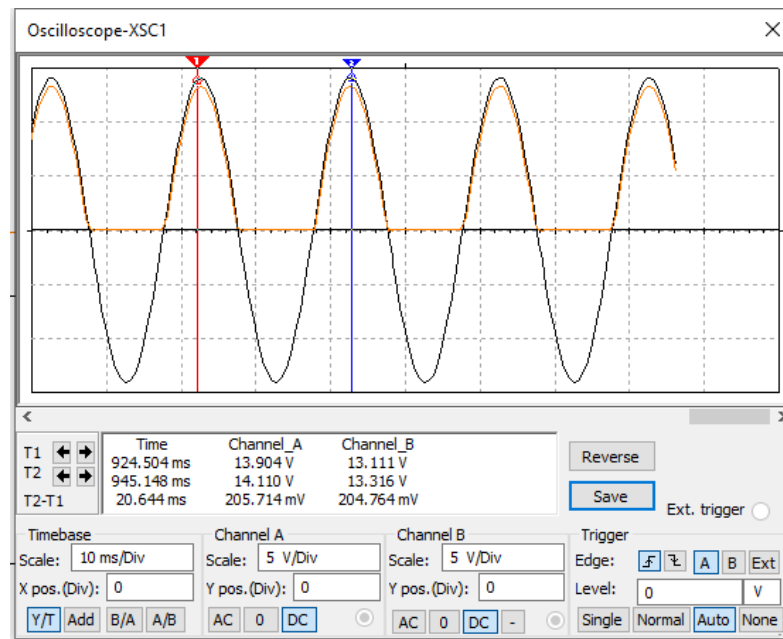
Рис. 2.6 - Осцилограми напруг однофазного однонапівперіодного випрямляча
