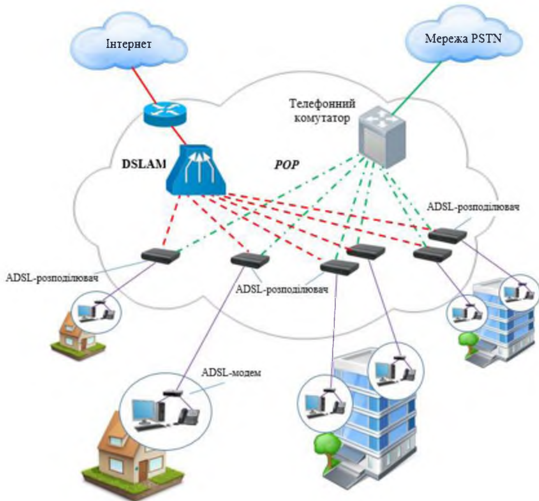
Рис. 8.10. Відмінності в роботі ADSL-модемів від комутованих модемів
