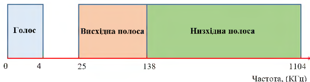
Рис. 8.11. Розподіл смуги пропускання абонентського закінчення між каналами ADSL
