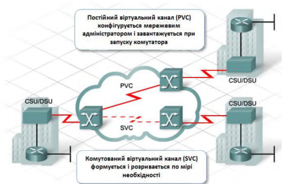
Рис. 4.9. Комутований та постійний віртуальні канали
