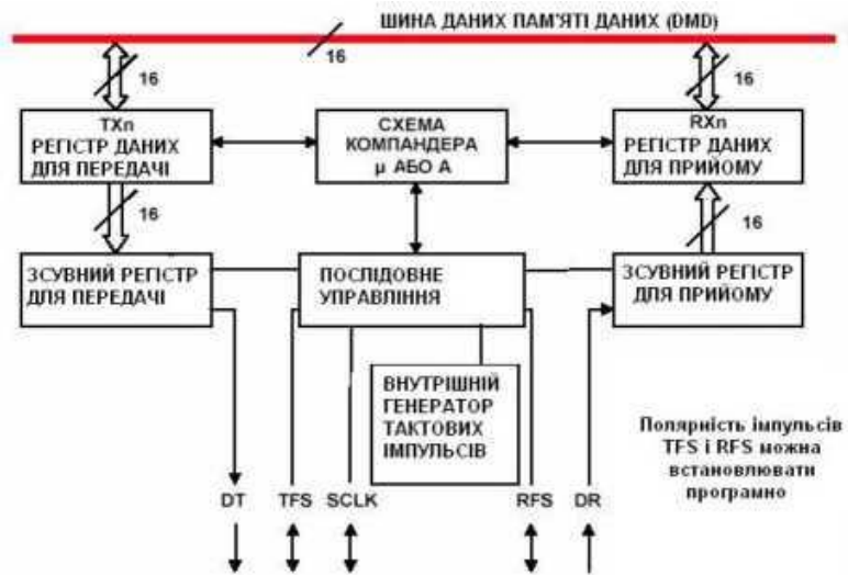
Рис. 8.8. Структурна схема послідовного порту процесора сімейства ADSP-21xx
