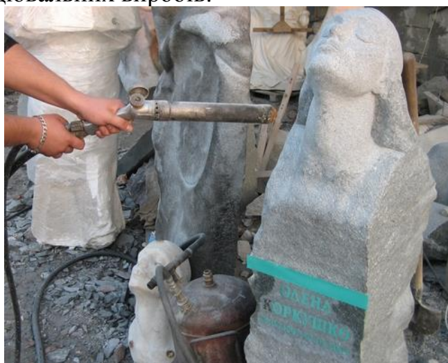
Рис. 15. Фактурна обробка каменю ручним термовідбійником
