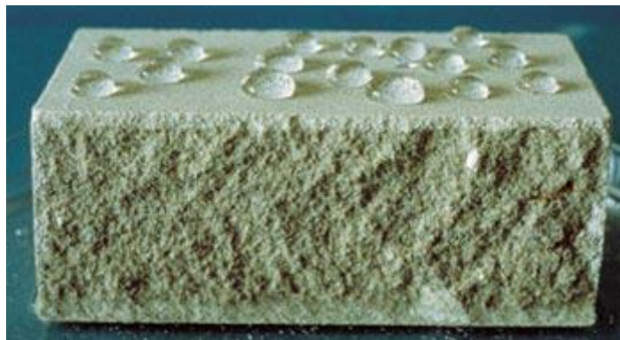
Рис. 70. Водовідштовхування на поверхні матеріалу, який оброблений гідрофобізатором.
