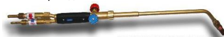
Рис. 14. Інжекторний пальник типу L-100/12
