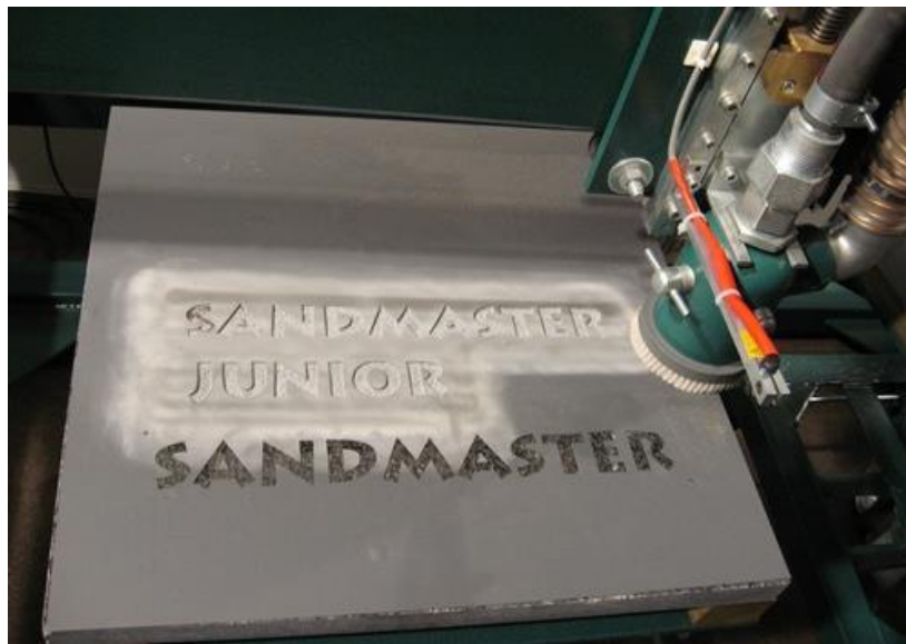
Рис. 57. Обробка каменю піскоструминним верстатом
