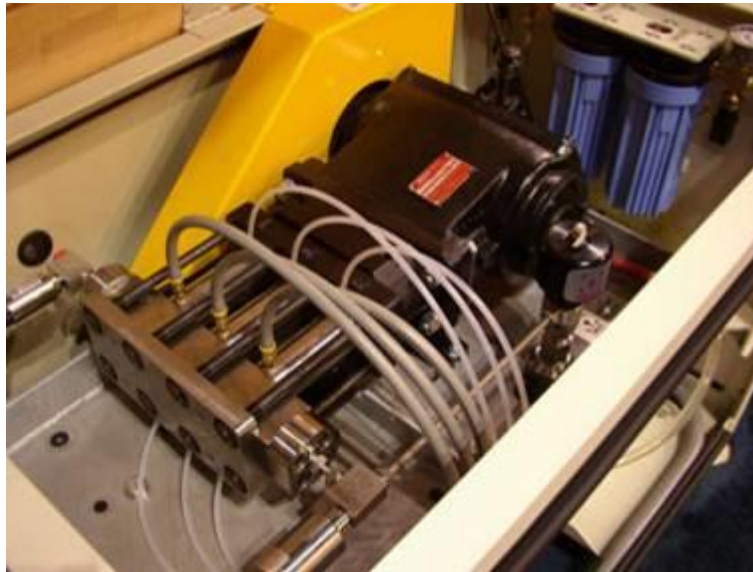
Рис. 33. Насос високого тиску прямої дії: у правій частині видно два (з п'яти) фільтрів води, у середній – сам кривошипно-шатунний механізм та у лівій – три циліндри високого тиску
