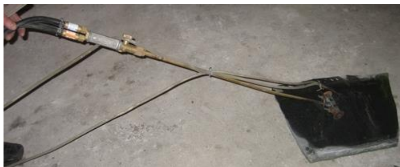
Рис. 10. Фактурна обробка природного каменю термогазоструминним пальником
