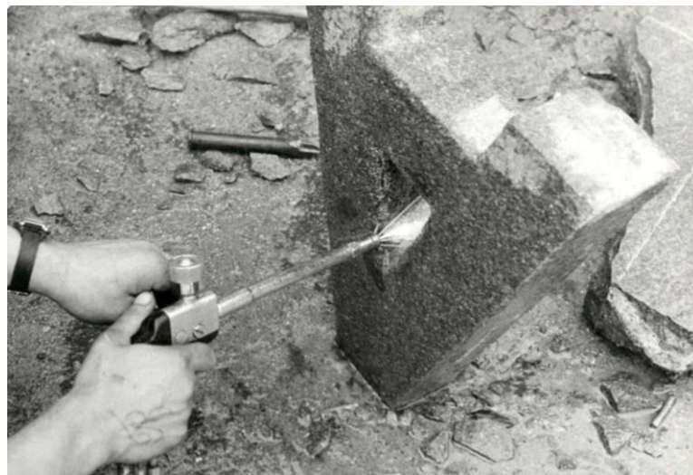
Рис. 16. Вирізання букв із граніту терморізаком "С-6/16-1"
