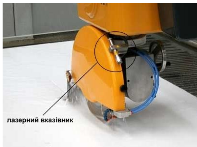
Рис. 23. Розпилювання мрамору фрезерно-окантовувальним верстатом
