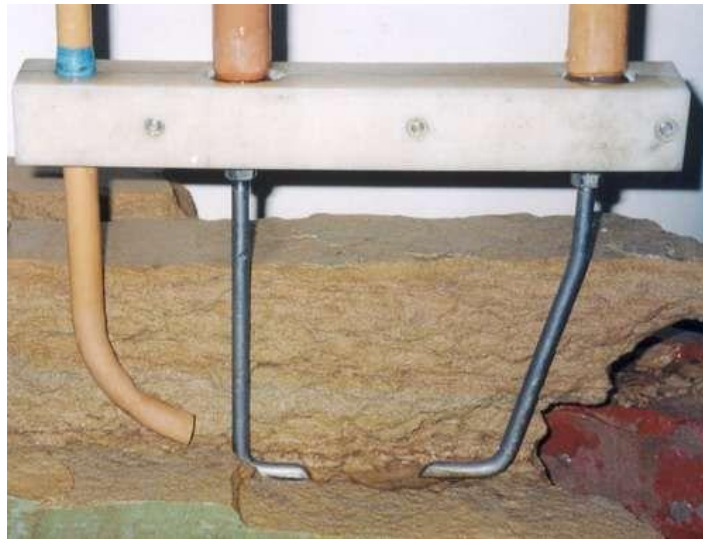
Рис. 6. Процес різання піщаника ЕІ способом
