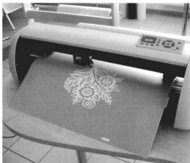
Рис. 58. Вирізання рисунку різальним плотером
