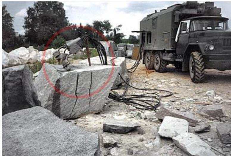
Рис. 8. Направлене розколювання (пасерування) блока граніту із застосуванням 3-х енерговиділяючих вузлів
