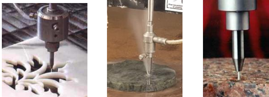
Рис. 26. Процес гідроабразивного різання каменю
