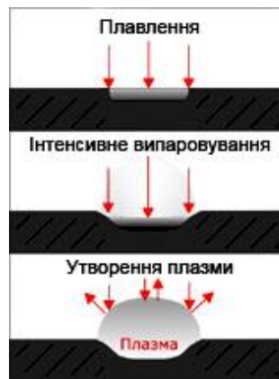
Рис. 17. Фази лазерної обробки
