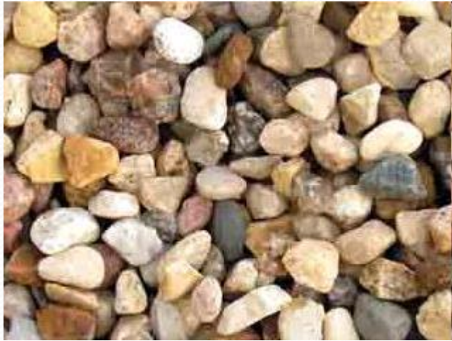
Гравій – це зерна з розмірами від 5 мм до 70 мм
