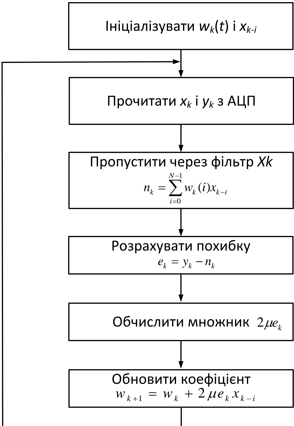
Рис. 8. Функціональна схема адаптивної фільтрації за схемою найменших квадратів
