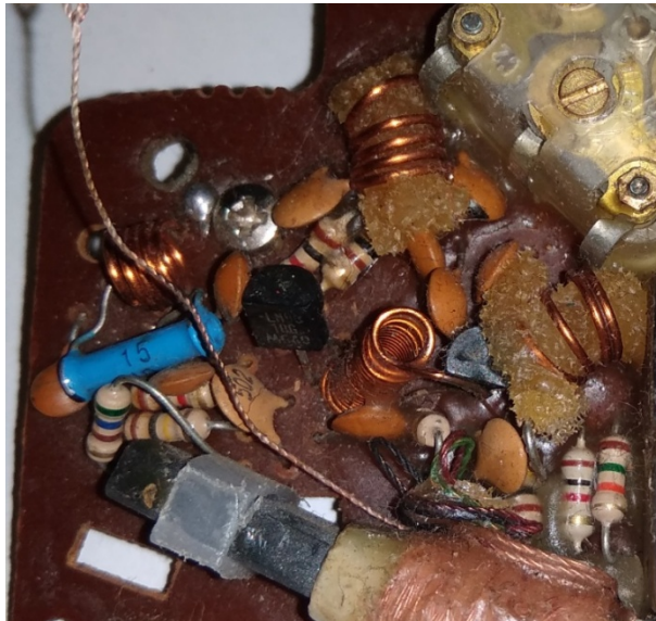
Рис.3.1 – Приклад розміщення контурних котушок на друкованій платі
