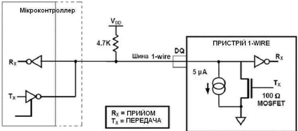
Рис. 1. 1. Схема обміну по 1-wire інтерфейсу
