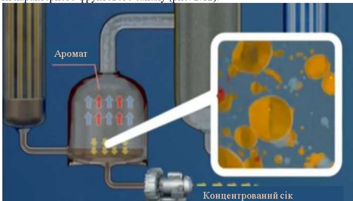
Рис. 2.12. Схема випарювання із соку рідини разом із ароматом у вакуум-випарній установці
