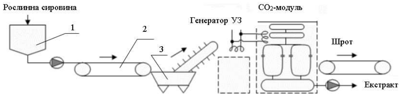
Рис. 3.8. Технологічна схема виробництва екстрактів шляхом \text{CO}_2 -екстракції: 1 – бункер-приймач; 2 – стрічковий транспортер; 3 – мийна машина
