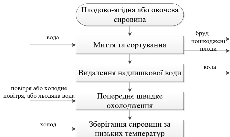
Рис. 1.20. Схема зберігання сировини за допомогою штучного холоду
