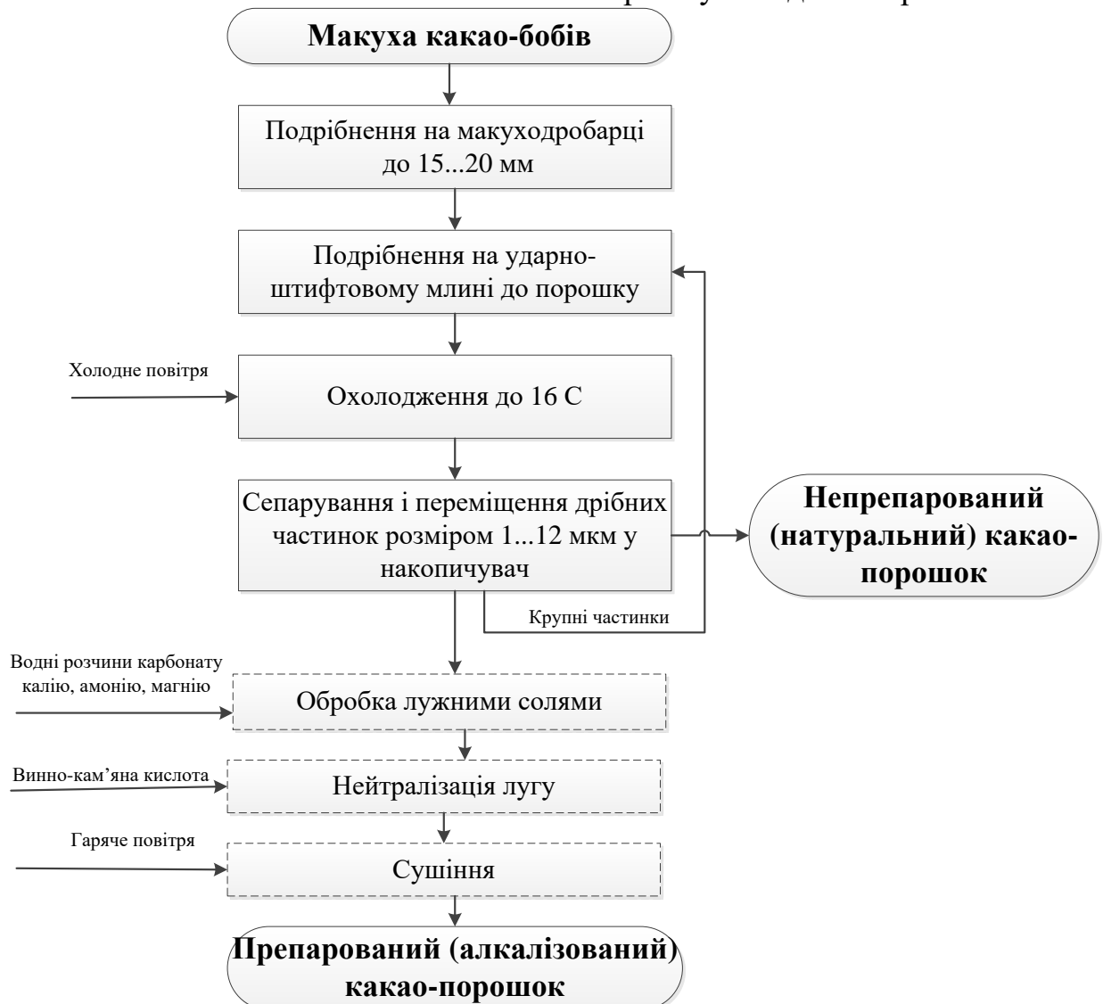
Рис. 4.19. Принципово-технологічна схема виробництва какао-порошку
