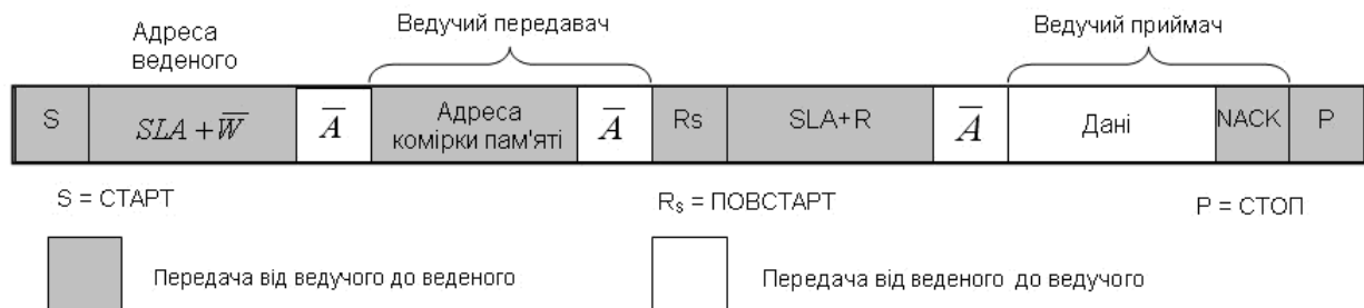
Рисунок 3.24 – Приклад звернення до зовнішньої пам'яті даних типу EEPROM
