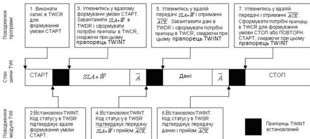
Рисунок 3.19 – Приклад взаємодії програми з модулем TWI
