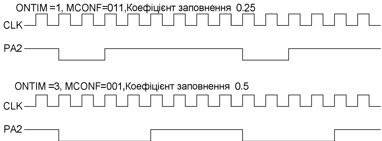
Рисунок 8 - Приклади сигналів, що формуються апаратним модулятором
