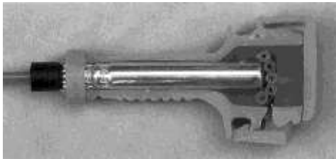
Рис. 2.6. З'єднувальний замок системи Нонель, який містить в собі капсуль детонатор
