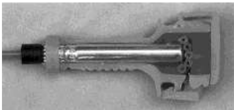
Рис. 2.6. З'єднувальний замок системи Нонель, який містить в собі капсуль детонатора
