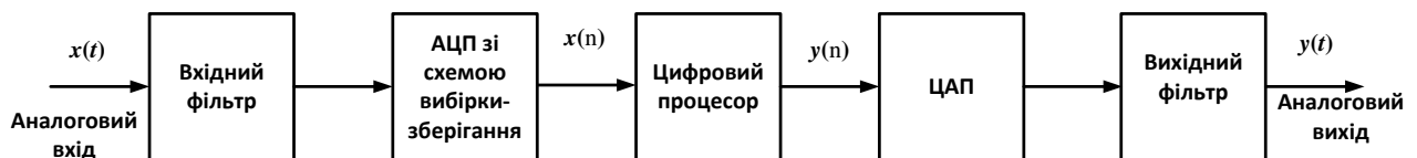
Рис. 1. Спрощена блок-схема цифрового фільтра реального часу з аналоговим вхідним та вихідним сигналами
