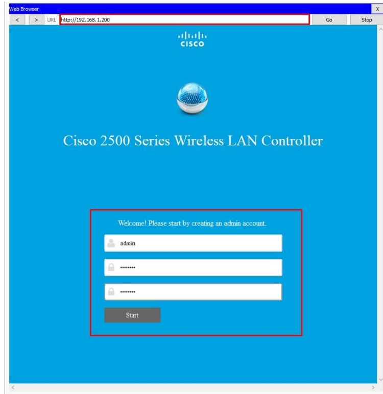
Рисунок 11 – Початкові налаштування Wirelles Lan Controller
