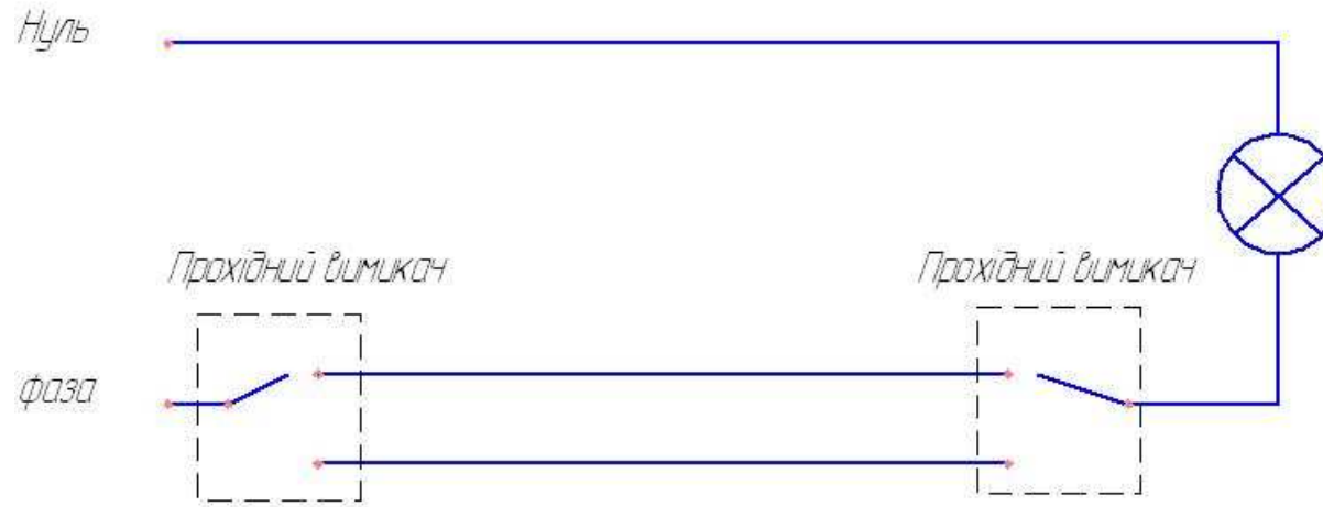
Рис. 1. Схема підключення 2-х прохідних вимикачів
