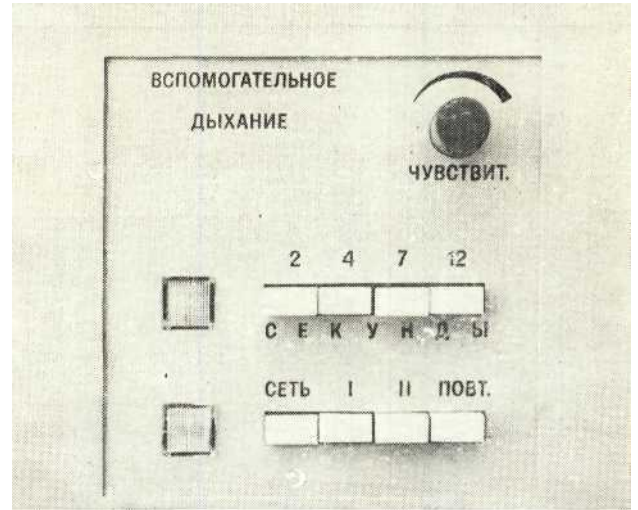
Рис. 25. Панель блока вспомогательной вентиляции
