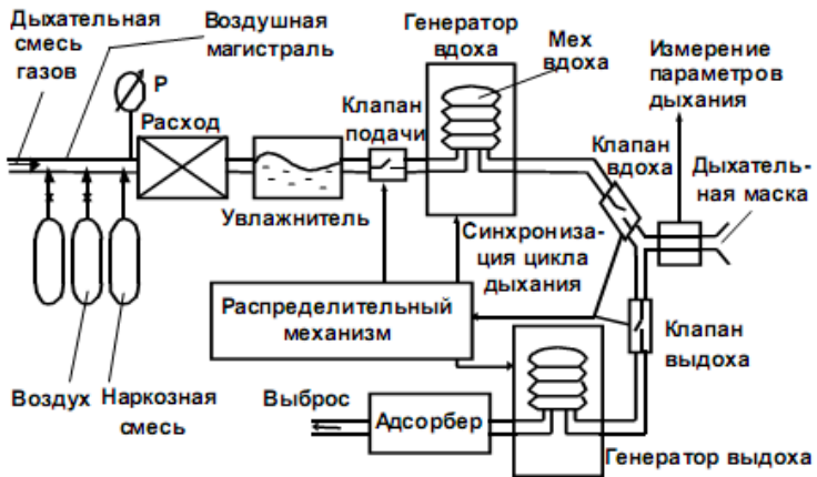
Рис. 13.2. Схема апарату для ШВЛ
