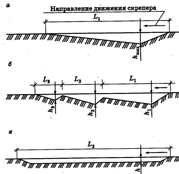
Рис. 2.18. Схемы резания грунта скрепером: а — клиновидная стружка; б — гребенчатая стружка; в — тонкая стружка; L_1, L_2, L_3 — длина пути набора грунта
