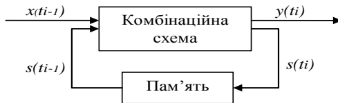
Рис. 3.13. Функціональна структура скінченного автомата
