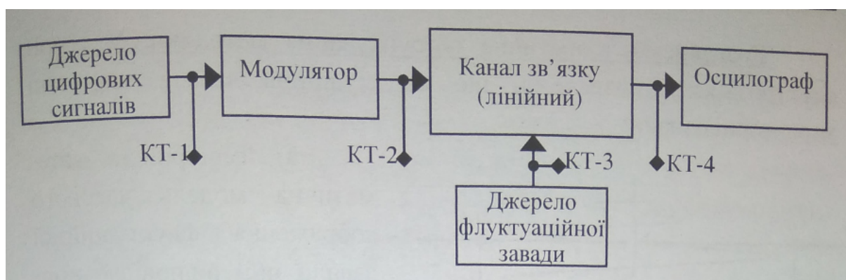
Рис. 6.1. Структурна схема макета цифрової системи передавання інформації
