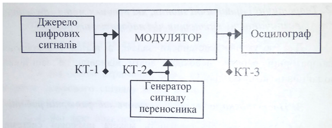
Рис. 1.3. Структурна схема макета фрагменту цифрової системи передавання інформації
