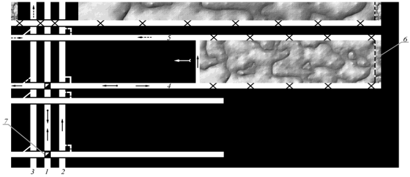
Рис. 6– Стовпова система розробки лава-ярус
