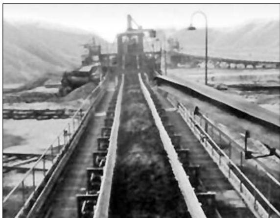
Рис. 5.25. Переміщення покрівельних порід конвеєрним транспортом
