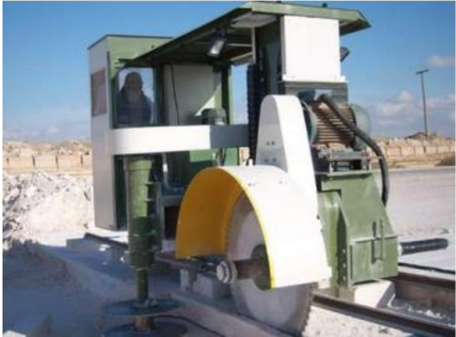
Машина з дисковими пилами низькоуступна SM-89A (підшвоуступна)
