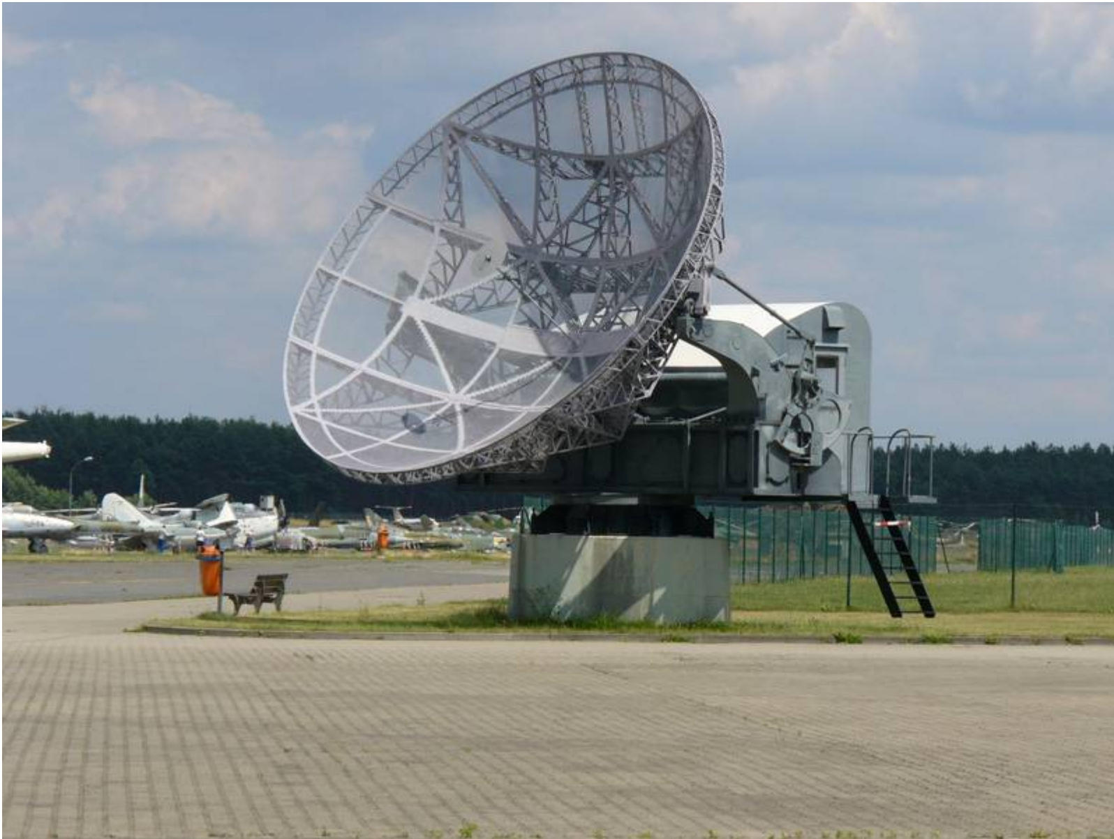
Приклад дзеркальної антени з сітчастим рефлектором
