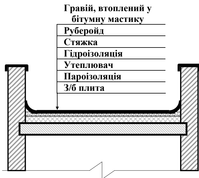
Рисунок 3.25 - Схема суміщеного покриття, що не вентилюється
