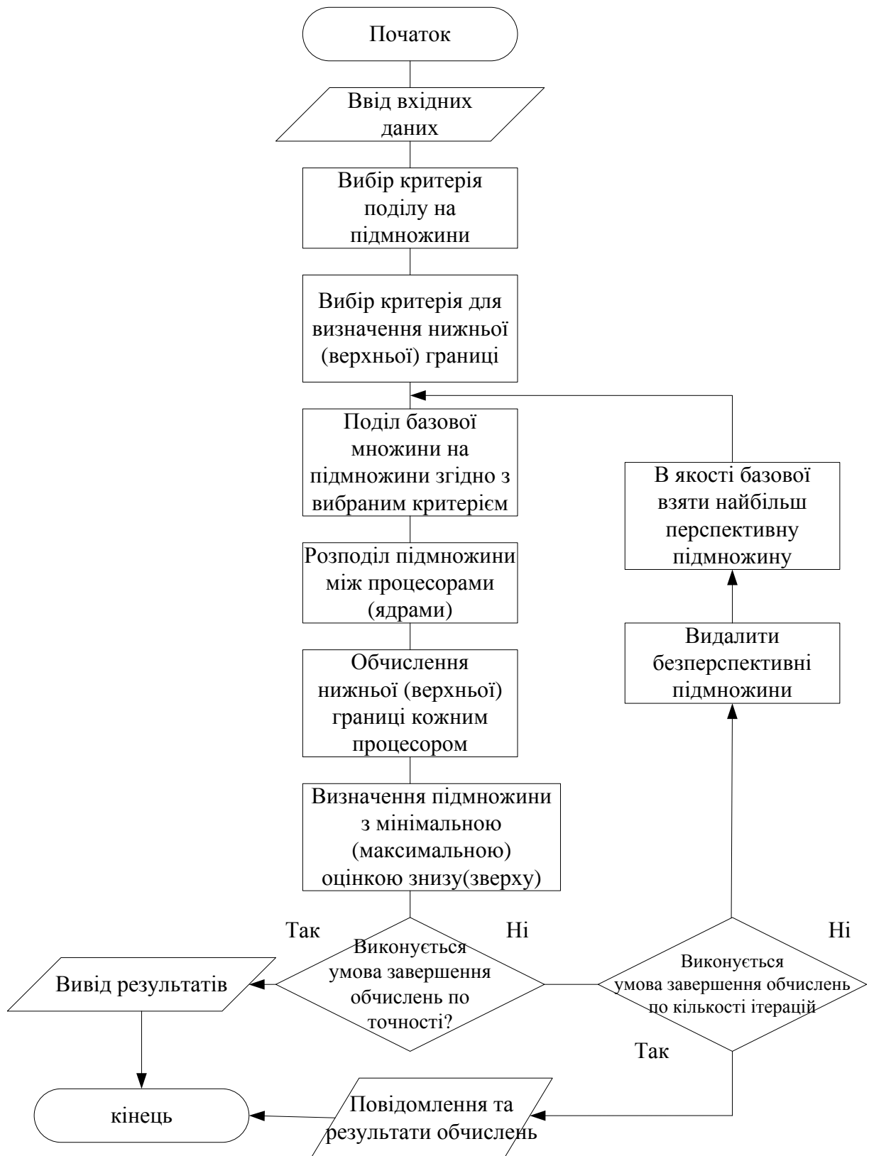
Рис.4.19. Блок-схема алгоритму застосування методу гілок та границь для розв'язку задач з використанням мультипроцесорної платформи
