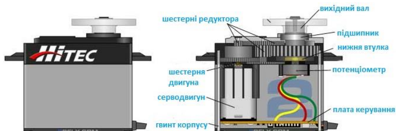
Рис. 2.5. – Внутрішня будова серводвигуна
