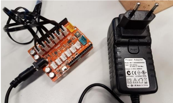
Рис. 2.8. – Модуль Braccio Shield та блок живлення модуля
