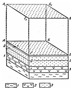
**Рис. 7.1.** Зображення на геологічній карті горизонтальне залягання пластів в умовах горизонтального рельєфу
