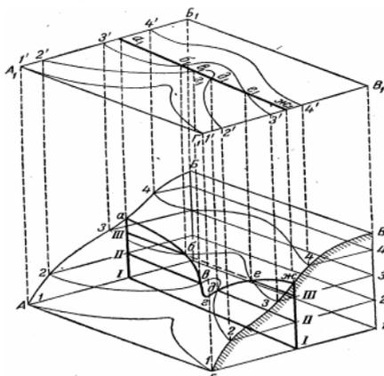
**Рис. 7.5. Зображення на геологічній карті вертикально залягаючого пласта**
