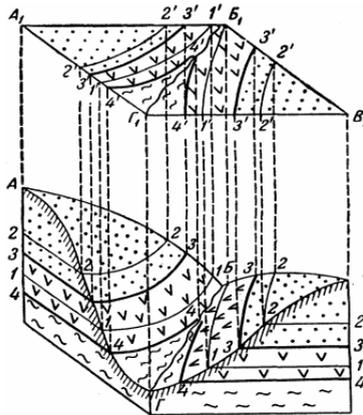
**Рис. 7.2. Зображення на геологічній карті горизонтально залягаючих пластів в умовах перетнутого рельєфу**
