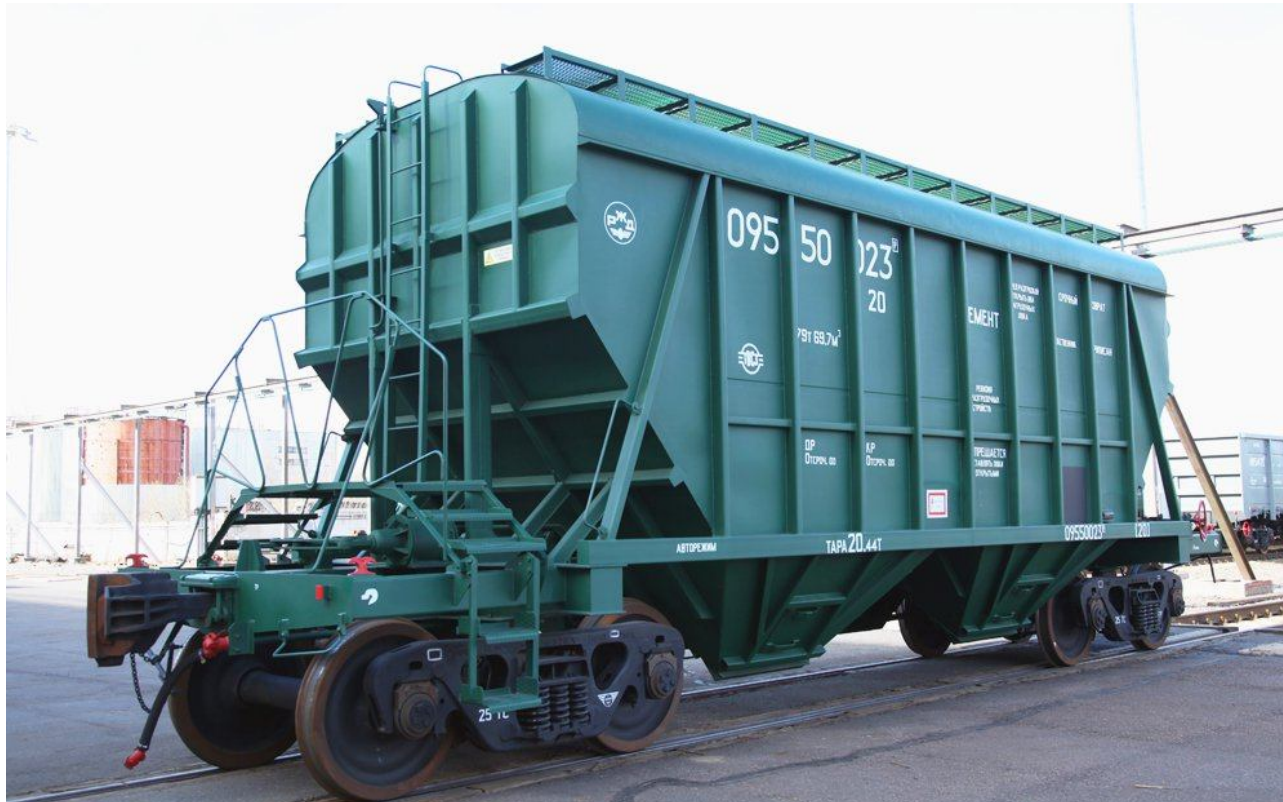
Рисунок 5.6 – Чотиривісний хопер для перевезення цементу
